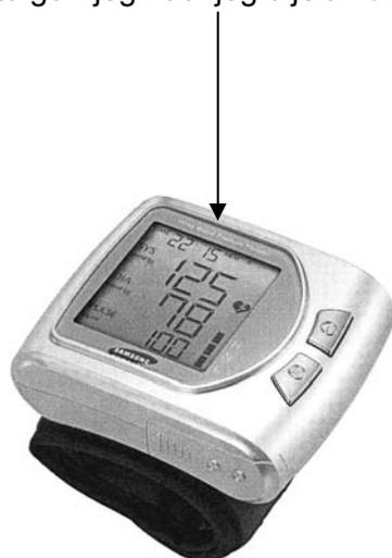
Slika 1: Izgled tlakomjera model SBM-100A s prikazom mjesta za smještaj ovjerne naljepnice
